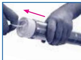
3. QUITAR LA TAPA SUPERIOR Y COLOCAR EL CARTUCHO DENTRO DE LA BOMBA DE FORMA QUE LA ANILLA QUEDE EN LA PARTE SUPERIOR. TIRAR DE LA ANILLA DE LA BASE DEL CARTUCHO Y ENROSCAR EL CABEZAL DE LA BOMBA.
