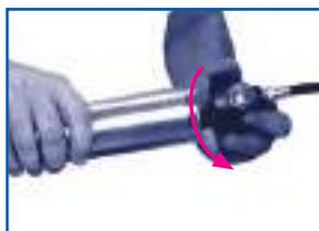
1. DESENROSCAR EL CABEZAL DE LA BOMBA.
