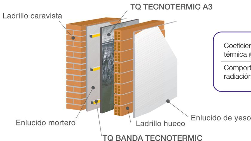
Coefficiente de transmisión térmica (UNE 1934:1998)  $R = 1,83 \text{ m}^2\cdot\text{K}/\text{W}$
