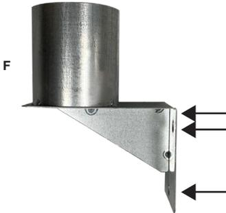
**6.** Realizamos los orificios con broca de  $\varnothing$  12mm, limpiamos el interior con TQ AIRE COMPRIMIDO, introducimos los tacos metálicos expansivos suministrados (H), le damos unos giros antes de colocar la cartela (F) por tal de sujetarlos.
