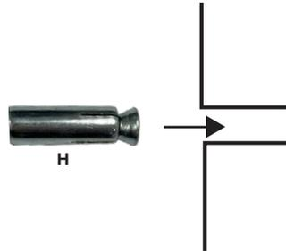
**7.** Instalamos la cartela (F) y unimos junto la arandela, retenedor y tuerca (H). Apriete la rosca hasta fijar la cartela a pared.
