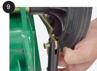
9 A manera de unión, insertamos el perno pasador con hebilla (E).
