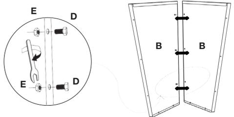
**3.** Fije el panel frontal (A) con el lateral (B) restante con los tornillos (D) y las tuercas (E) y únelo a los otros dos paneles laterales fijados en el anterior paso.
