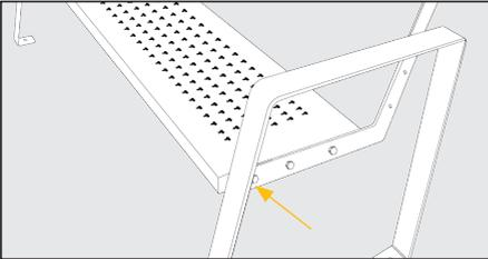
1. Conecte el asiento con una de las patas de acero mediante tornillos DIN 7380 INOX M8x25mm, arandela DIN 125 INOX M8 y tuercas M8 DIN985. No apretar del todo para permitir trabajar con mayor facilidad. Repetir el proceso anterior en la otra pata.
