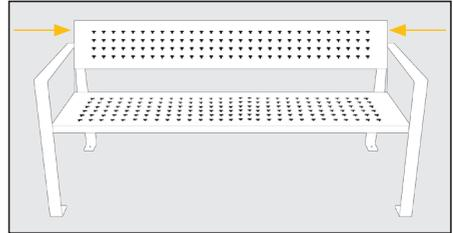
2. Conecte el respaldo con las patas de acero con tornillo DIN 7380 INOX M8x25mm, Arandela DIN 125 INOX M8 y las tuercas M8 DIN985. No apretar del todo para permitir trabajar con mayor facilidad.
