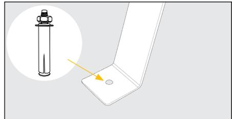
4. Coloque el banco en su lugar. Haga agujeros para los anclajes de fijación ( $\varnothing 12\text{mm}$ ) y utilice los tornillos expansivos para asegurar el banco al suelo.
